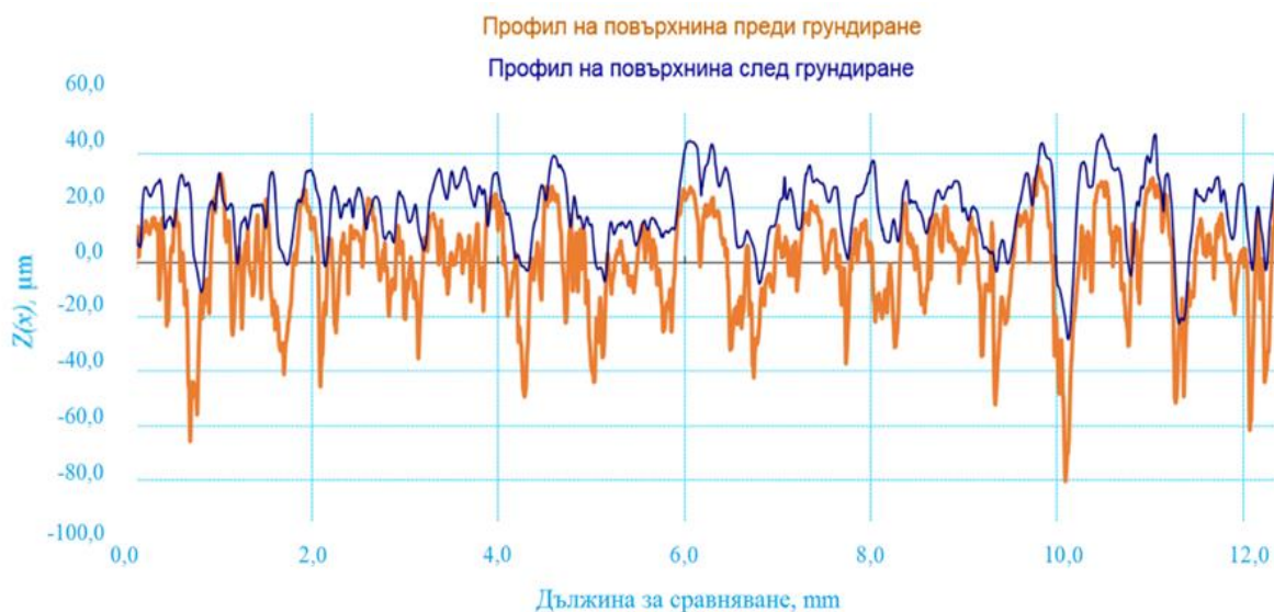
Фигура 1. Изменение на профила на шперплатна повърхнина в резултат от грундиране [6]
