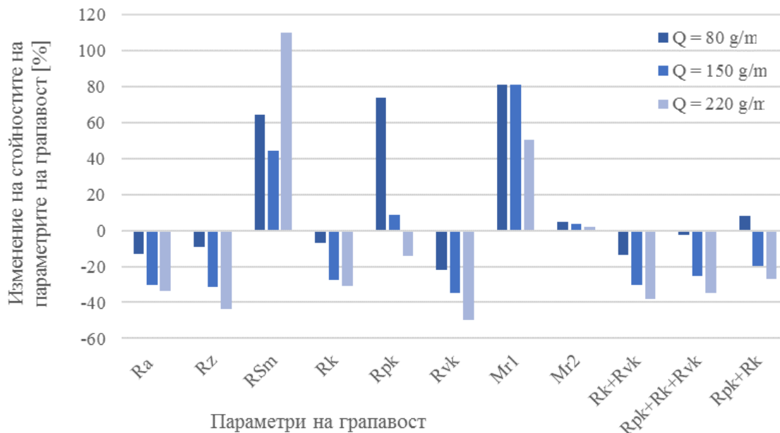
Фигура 3. Изменение на стойностите на изследваните параметри на грапавост при грундиране с различно количество грунд
